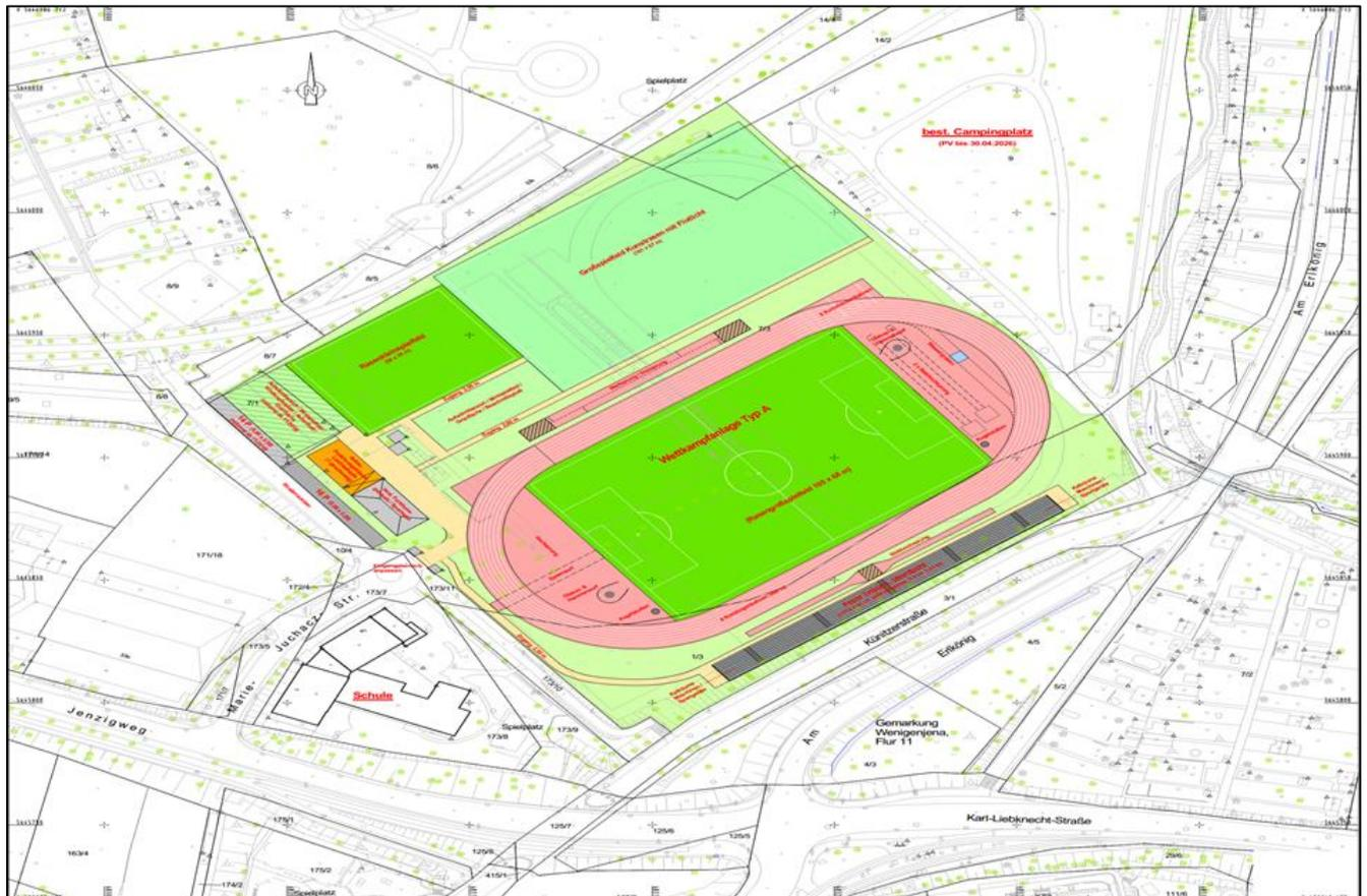
Abbildung 26: Plan Nr. 2.2.3.1 - Lageplan „Jenzigweg“: Variante 2.2.3.1, Nord-Süd-Ausrichtung, kurze Tribüne Ostseite (2 Groß- und 1 Kleinspielfeld neu)
