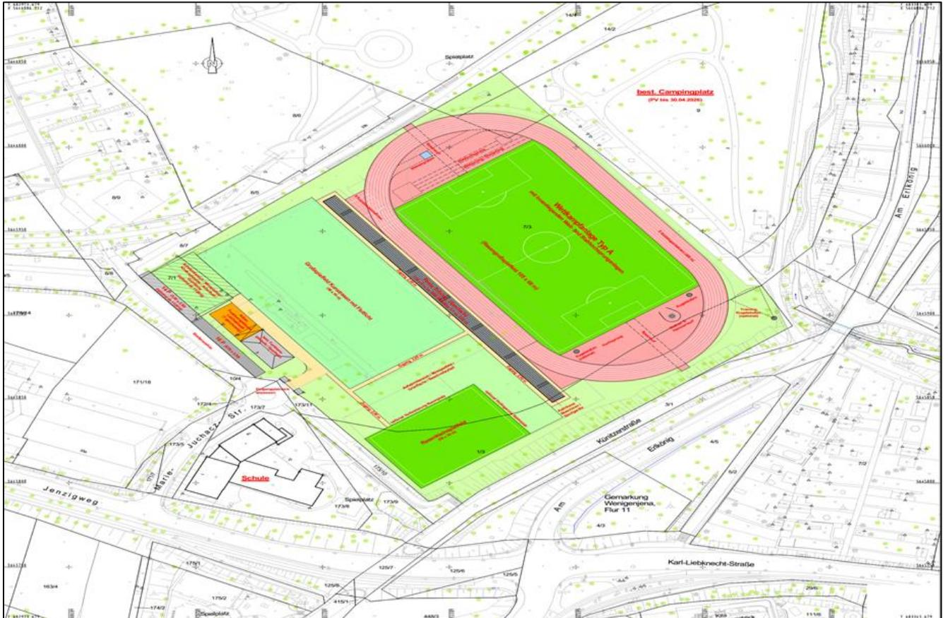
Abbildung 22: Plan Nr. 2.1.2.1 - Lageplan „Jenzigweg“: Variante 2.1.2.1, West-Ost-Ausrichtung, innenliegende Weit- und Stabhochsprunganlagen
