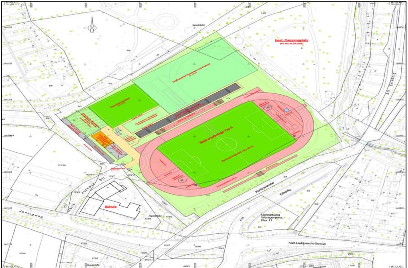
Abbildung 25: Plan Nr. 2.2.2 - Lageplan „Jenzigweg“: Variante 2.2.2, Nord-Süd-Ausrichtung, kurze Tribüne zentral
